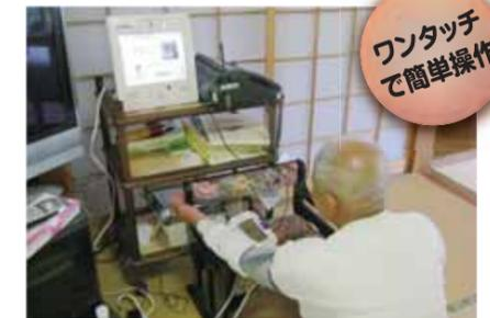
血圧計を接続し、測定データをセンターへ送信します。送信されたデータは、グラフなどで表示できます。
